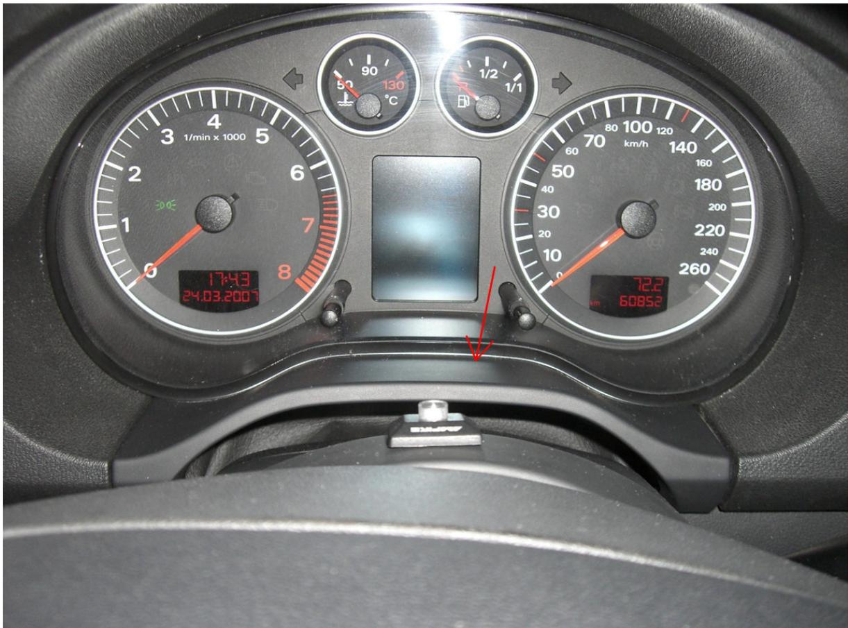
Unter dieser Plastikverkleidung liegen links und rechts zwei Schrauben, die Ihr mit einer 8 Nuss lösen müsst:
