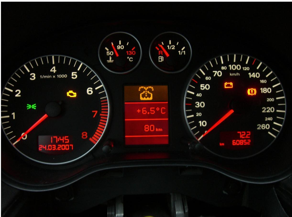
Nun werdet Ihr sicher denken, dass die Drehzahl nicht korrekt ist! Ist aber FALSCH! Da sich das KI die Daten vom CAN-BUS holt, bleibt die Genauigkeit der Drehzahl und der Geschwindigkeit gegeben.
