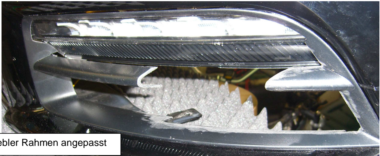
Wo der Nebler saß ist der „Mittelsteg“ offen. Aus einem 2. Neblerahmen ein passendes Stück herausgetrennt und in die Lücke eingepasst.
