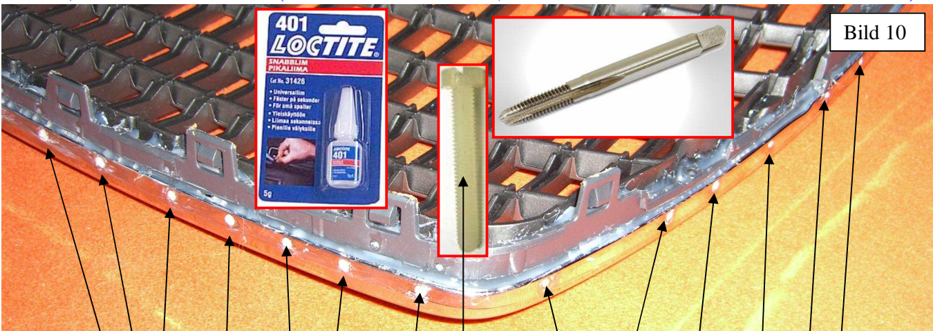
Bild 10, die verbundenen Teile. (A6 allroad SFG Innenteil, A3 SFG Aussenteil und A3 SFG Chromrahmen)
