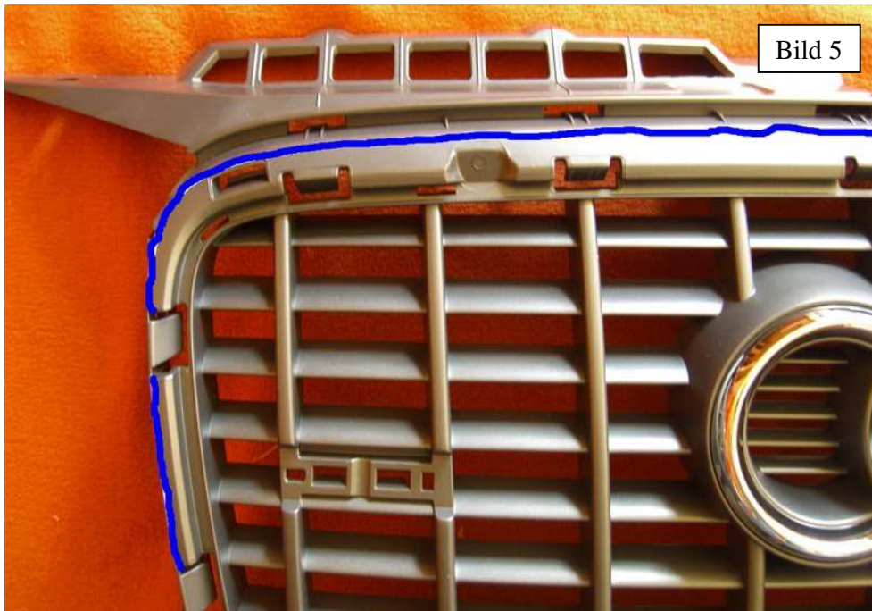
Bild 5, A3 8P bzw. 8PA SFG Vorderseite Ausschnitt (Blaue Linie ~ Schnittkante.)
