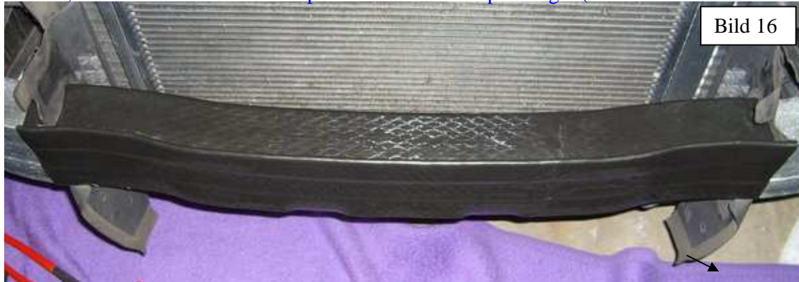
Bild 16, mit Terodem SP 300 Dämmplatten beklebter Aufprallträger (nur vorne und oben beklebt)
