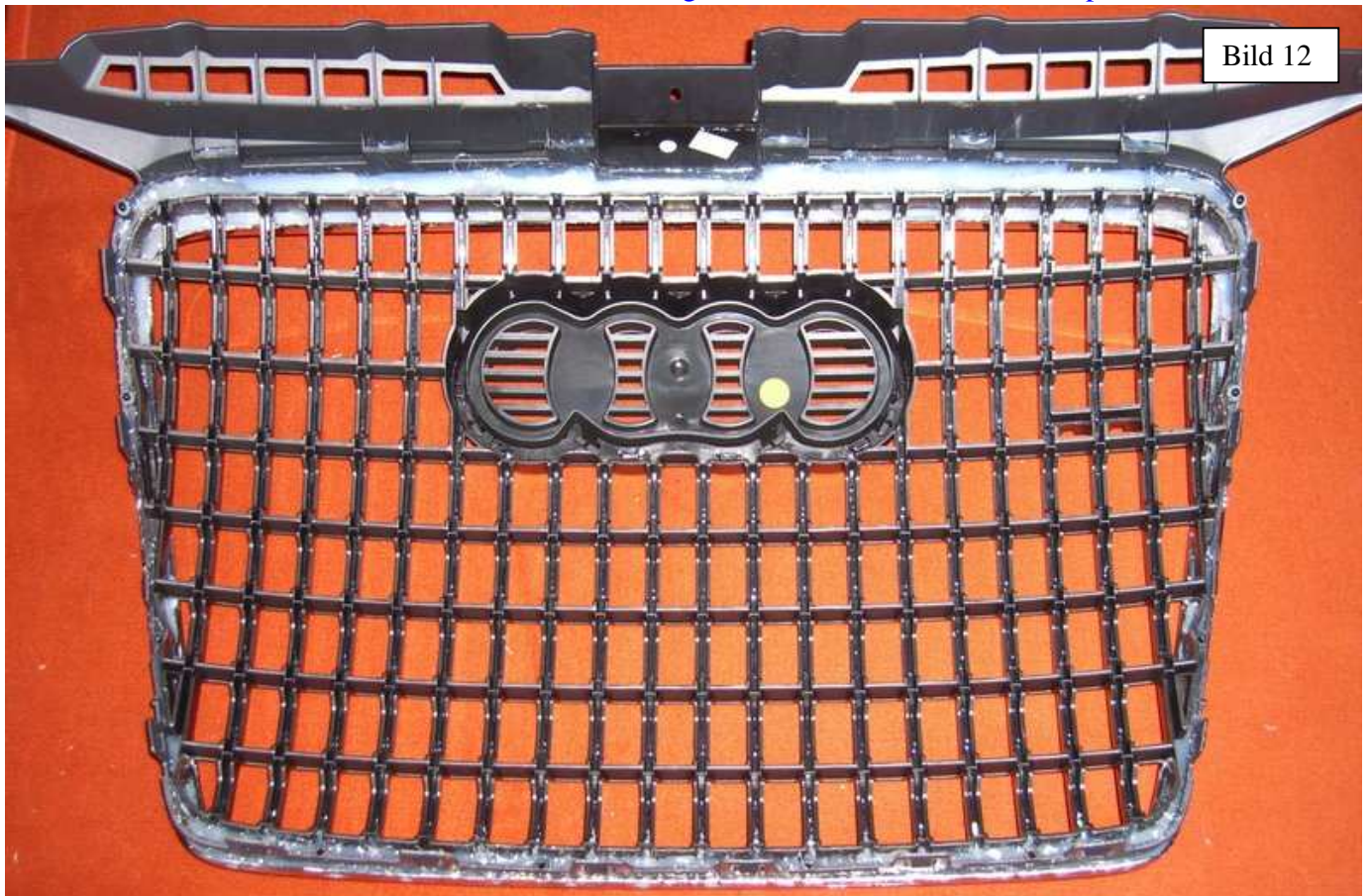
Bild 12, die Rückseite des „neuen“ A3 allroad SFG fertig verschraubt und mit Heissklebepistole verklebt.
