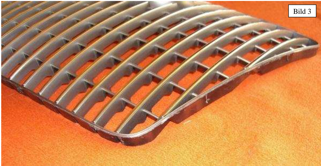
Bild 3, das herausgetrennte Innenteil des A6 allroad SFG im Detail.
